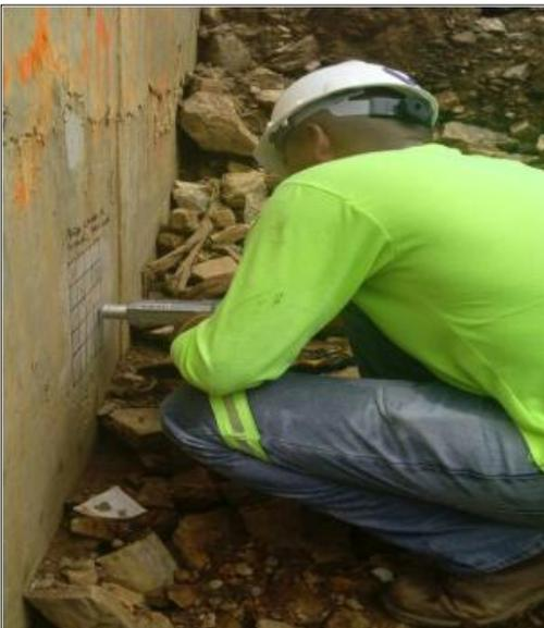
*Ilustración 6 Ensayo Windsor Pin*
