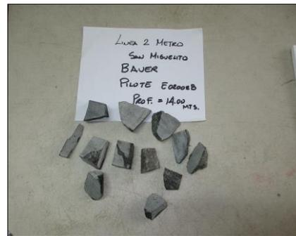
Ilustración 3 Fragmentos de roca obtenidos a la profundidad de desplante del pilote.
