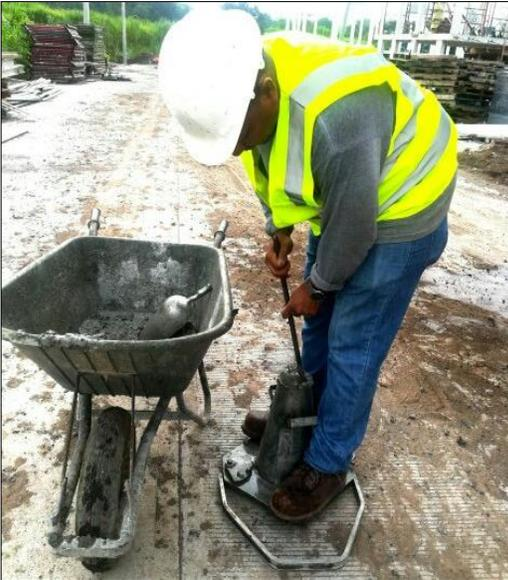
*Ilustración 4 Prueba de Slump*
