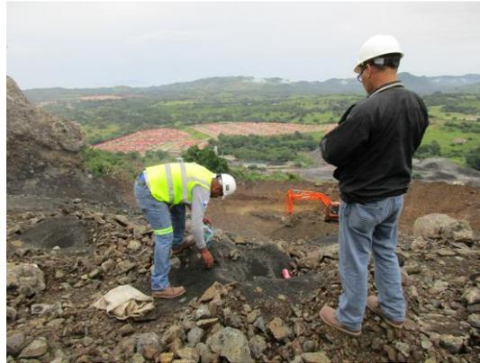
Ilustración 2 Muestreo de Materiales para Certificación.
